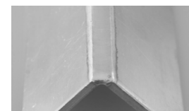
Сварка Алюминия Режим: AC + HYPER.PULS без присадки
